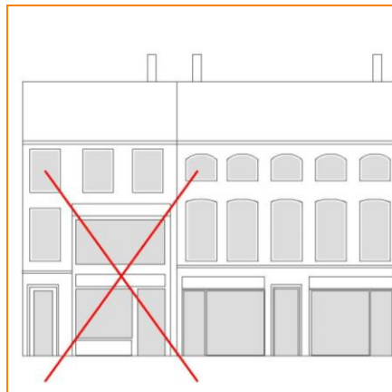
Uitdrukking van de handelsactiviteit onder de dorpel van de gevelopeningen van de 1e verdieping
